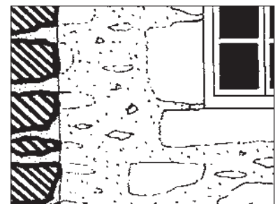
Joint à pierre vue
